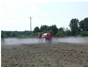
Taimekaitsetöödel kasutatavaid suure haardelaiusega mürgipritse karstilehtrid ei takista, eriti kui alad pole põllul tähistatud.
