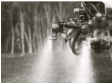
Pulvérisation de pesticides au moyen de buses sur un terrain de golf.
